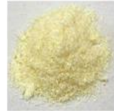
Καθαρή κυτταρίνη από υδροθερμικά επεξεργασμένη βιομάζα μέσω εκχύλισης για απομάκρυνση της λιγνίνης
