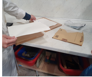
Εμποτισμένο σε MF φύλλο χαρτί που θα επιστρωθεί με τη μήτρα στη σανίδα με πρεσάρισμα υπό κατάλληλη θερμοκρασία και πίεση
